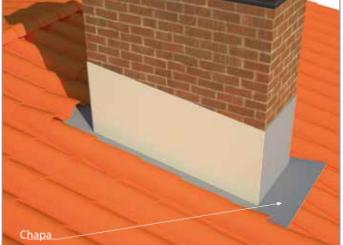
Rematar las placas Onduline Bajo Teja con lámina autoadhesiva Ondufilm de 45cm, pegándola sobre las paredes a una altura mínima de 20 cm.
